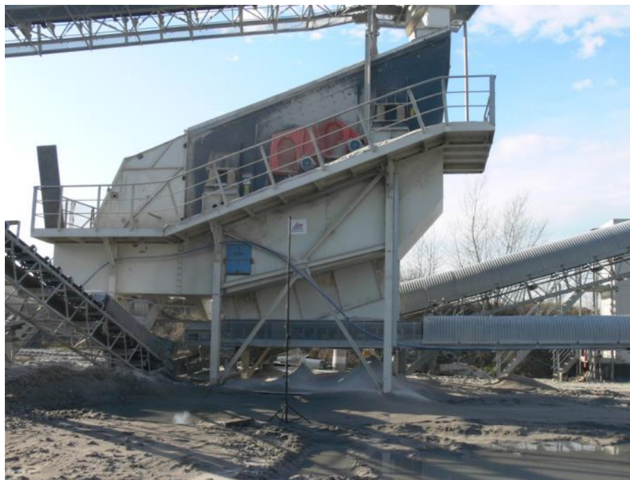
Fot. 22 Pomiar referencyjny przesiewacza CS173T
