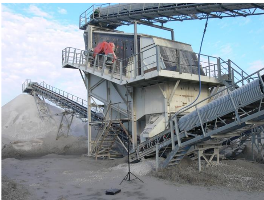
Fot. 24 Pomiar referencyjny przesiewacza SC2784
