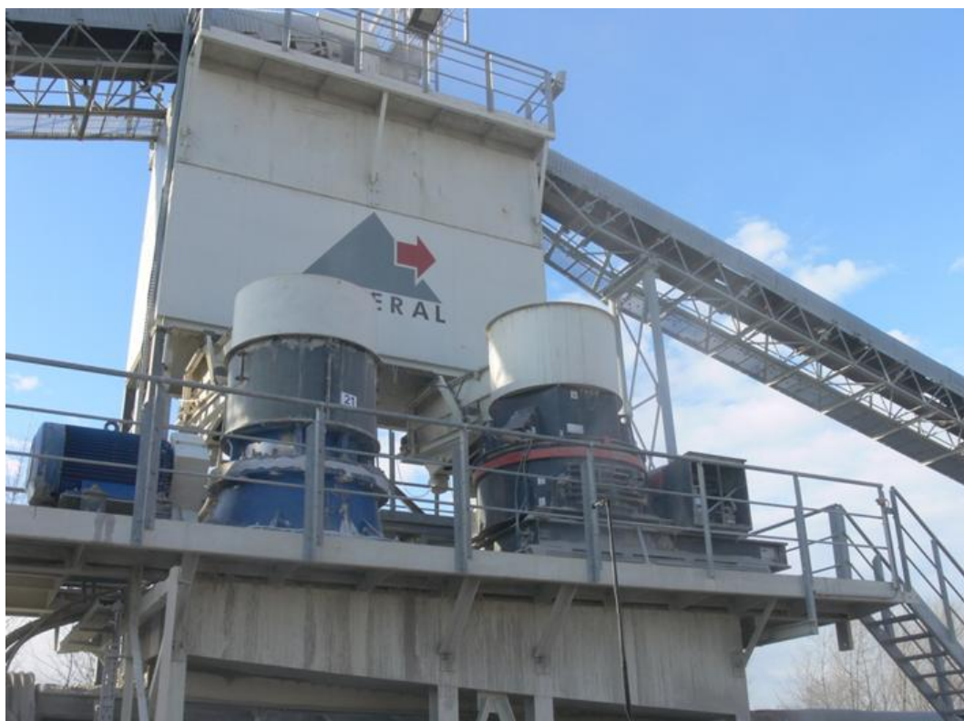
Fot. 7 Pomiar referencyjny kruszarek 3 i 4 (H488 i CV217) wraz z przesiewaczem nr 2 VFS(pkt 4)
