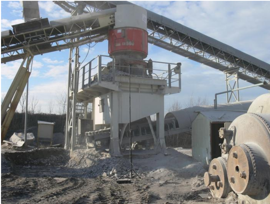
Fot. 5 Pomiar referencyjny kruszarki nr 2 (CH660) (pkt 2)
